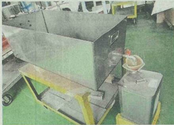
洗浄容器にフィルターを装着したじょうごを取り付け、洗浄液のリサイクル回数を増やした改善提案(坂口製作所提供)
