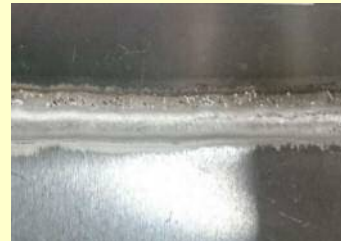
アルミ薄板の溶接（板厚0.3mm） アルミとステンレスの突合せ溶接（上がSUS、下がAL）
