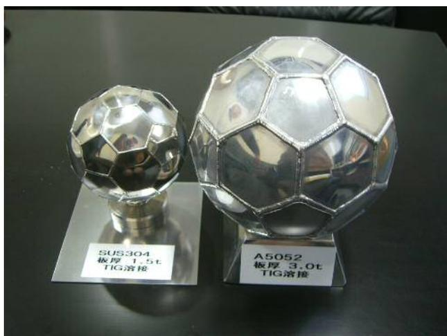
写真1 溶接構造のサッカーボール
