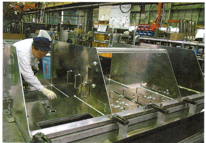
製作中の新幹線主変換筐体—有田川町で
